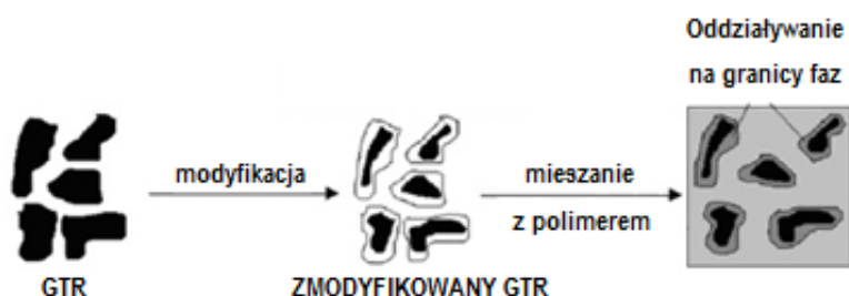
Schemat 1. Kompatybilizacja mialu gumowego z matrycą polimerową. [3]
