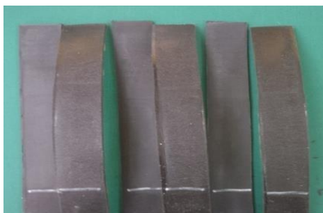
Zdjęcie. Próbkę bez nałożonego primeru (na lewo) – niska wytrzymałość mechaniczna, próbki z nałożonym primerem, zniszczenie kohezyjne taśmy klejącej (na prawo).
