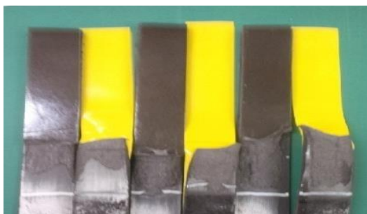
Zdjęcie. Próbkę bez nałożonego primeru (na lewo) – niska wytrzymałość mechaniczna, próbki z nałożonym primerem, zniszczenie kohezyjne taśmy klejącej (na prawo).
