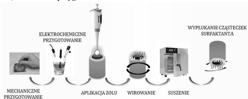
Schemat 1. Ogólna procedura przygotowania elektrody GC pokrytej błoną polisiloksanu.
