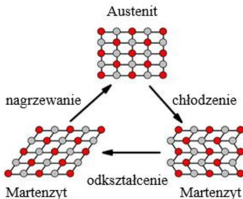
Schemat 1. Przemiany struktury krystalicznej nitinolu.
