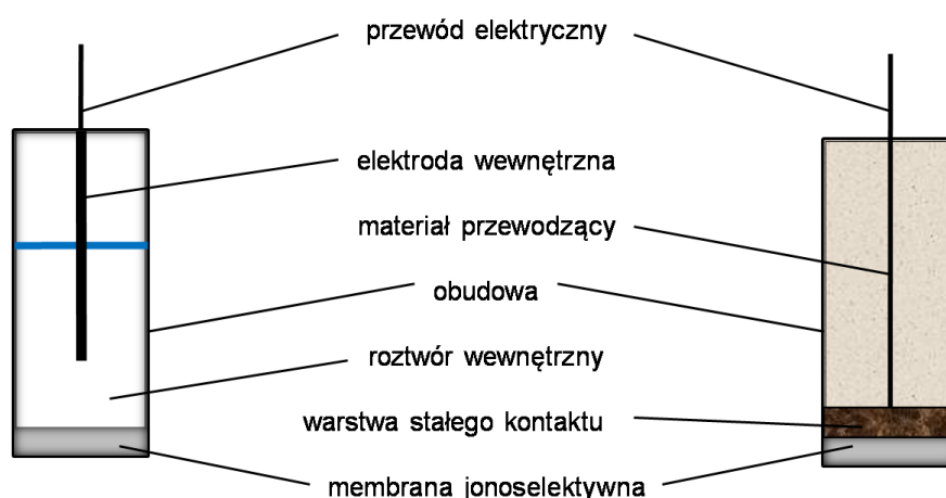
Rys. 1. Schemat budowy elektrody: a) klasycznej ISE z roztworem wewnętrznym, b) ISE z kontaktem stałym. 6
